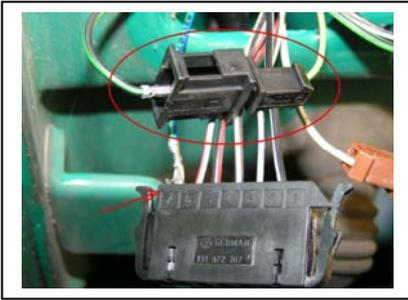
Vom 7Pol. Stecker, Pin 7 auspinen und Y-Kabel einbauen
