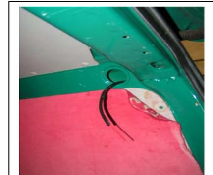
Dauerplus in Hecksäule bis zum Himmel legen und unter dem Himmel zur Beleuchtung führen
