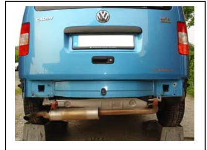
Demontierter Stoßfänger mit Grundträger
