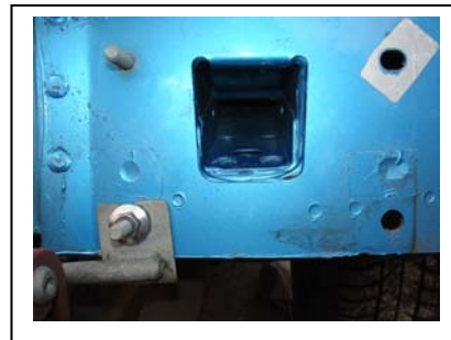
Chassisöffnung rechts, Punkt re. oben abkleben
