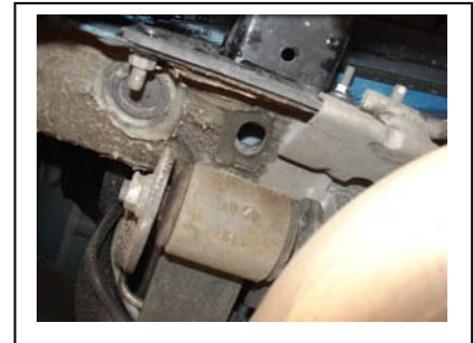
Demontage der Bolzen Grundträger
